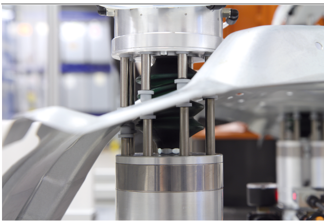
Sauger-Cup SSCB beim automatisierten Greifen und Spannen eines Blechteils
